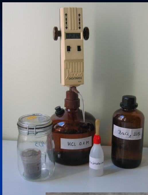
Zestaw do pomiarów tempa respiracji mikroorganizmów glebowych
